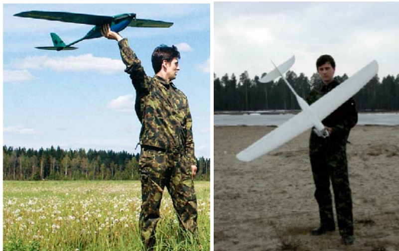
Слика 3 Мини беспилотна летелица BRAT у извиђачкој верзији (лево) и верзији ометача комуникацијских сигнала Мошкарц (десно)
